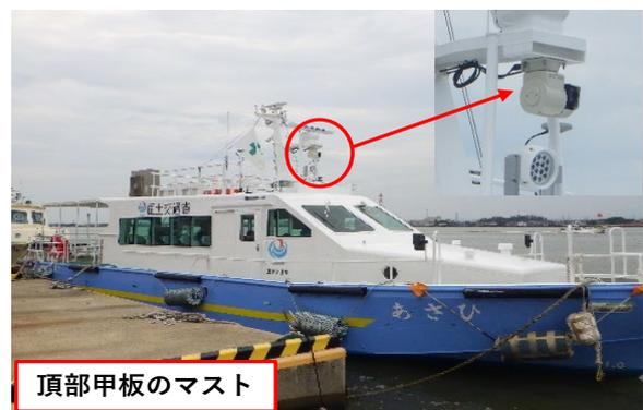
写真-8 旋回式カメラ
