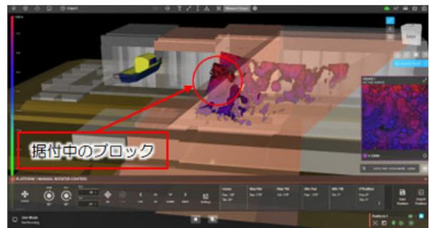
図-10 Echoscope(4Dソナー)
