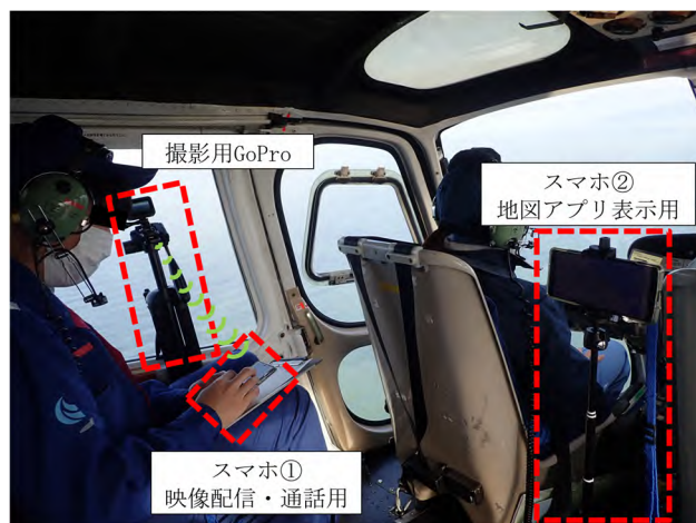
写真-3 機器配置状況
