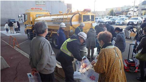
次に現地で水を配る方法は自然流下を基本にしており、水圧を掛けて給水するポンプ機能は飲料水として使用することを想定していないため、使用できなかった。そのため積載しているタンク吐出口より高さ高い水槽の給水口などへ給水が出来ない。
