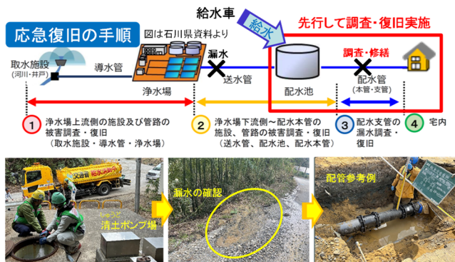
図4 配水管漏水調査・応急復旧への給水支援 7
