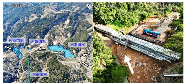
図5 河道閉塞の発生 図6 ブロック堰堤
