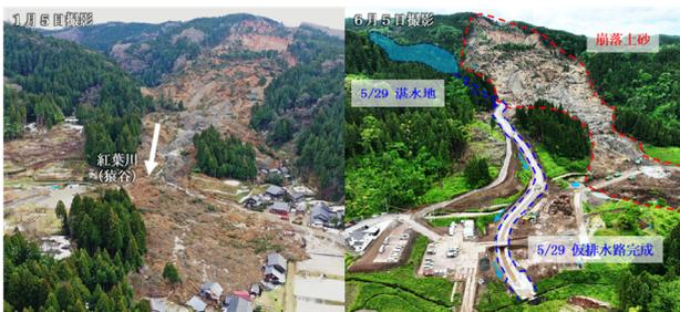
図3 大規模な土砂崩落 図4 仮排水路の完成
