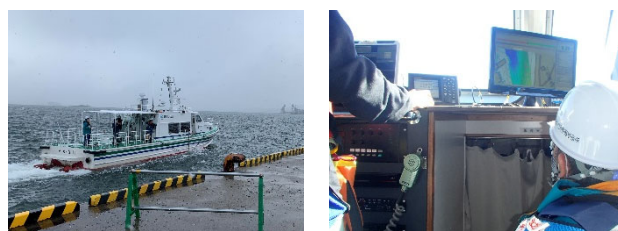
写真-8 港湾業務艇「わかなⅡ」による深浅測量(七尾港)
