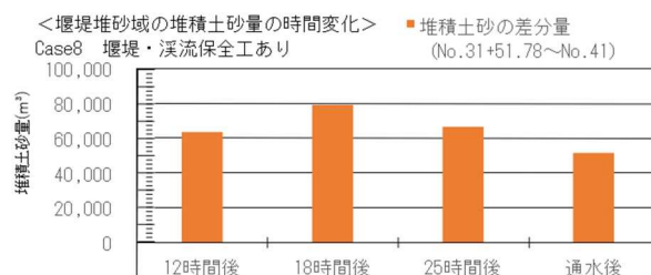
図12 透過型砂防堰堤上流側の時系列的な堆積土砂量（計画洪水波形）
