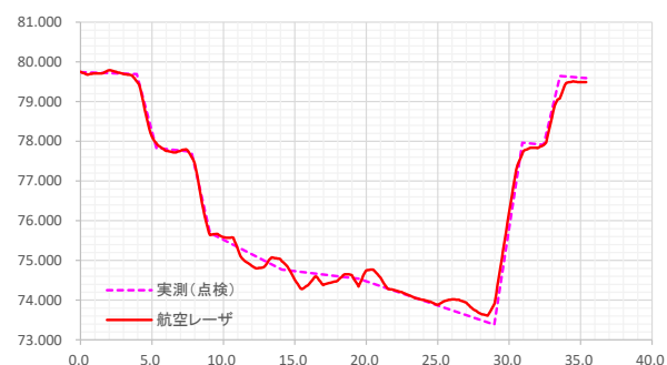
図-3 ALB計測データと実測データの比較断面図
