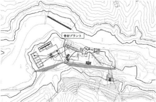
図-9 骨材プラント仮設備配置計画図
