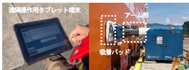
図-3 自動係留装置の構成
