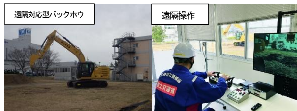
図-8 遠隔対応型バックホウの操作
