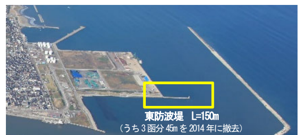
図-2 伏木地区 東防波堤ケーソン撤去前 (L=150m)
