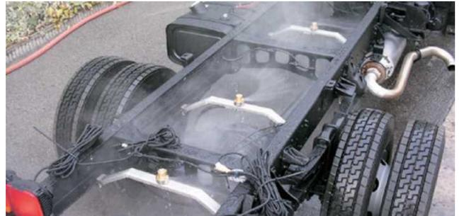
写真-5 凍結防止剤散布車の洗浄機構(共同特許取得済)
