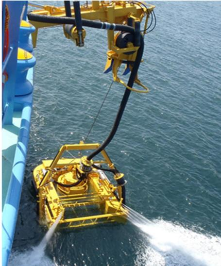
図-7 投げ込み式油回収装置更新
