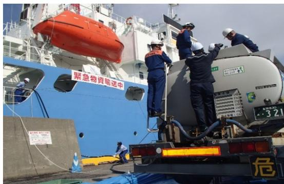
図-10 タンクローリーへの燃料油供給作業
