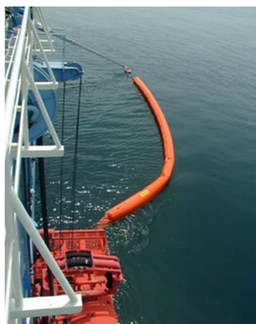
図-4 集油装置 (舷側設置式油回収装置併用時)
