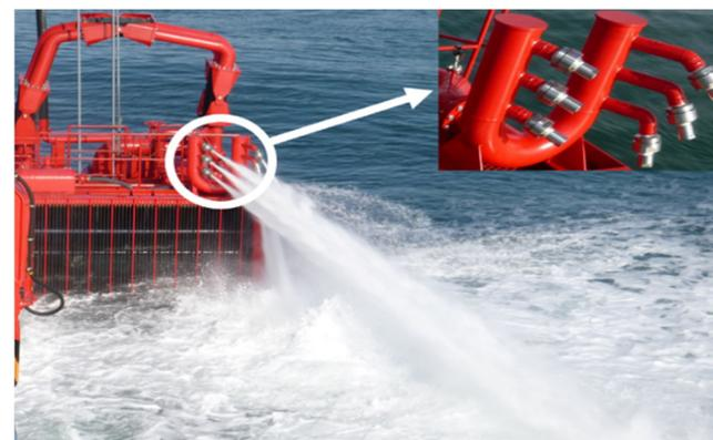
図-6 舷側設置式油回収装置に搭載した水ジェット式集油装置
