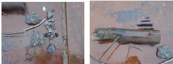
RC杭の破片と鉄筋
