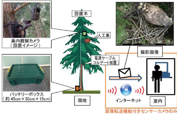
図-9 巣内観察カメラを用いたモニタリング手法
