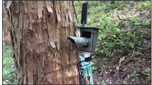
写真-1 遠隔監視カメラ
