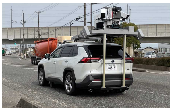
写真-2 MMS計測状況
