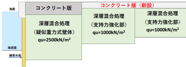
図-6 疑似重力式岸壁の断面イメージ図
