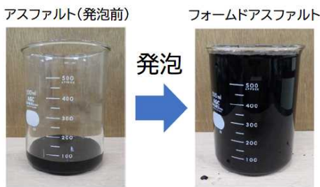
写真-2 フォームドアスファルト
