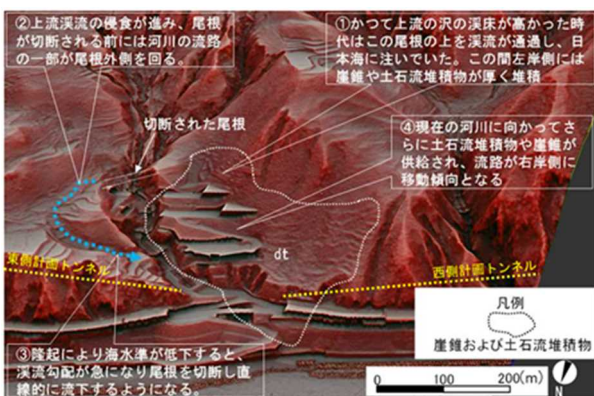
図-5 地形解析結果(西側トンネル部)
