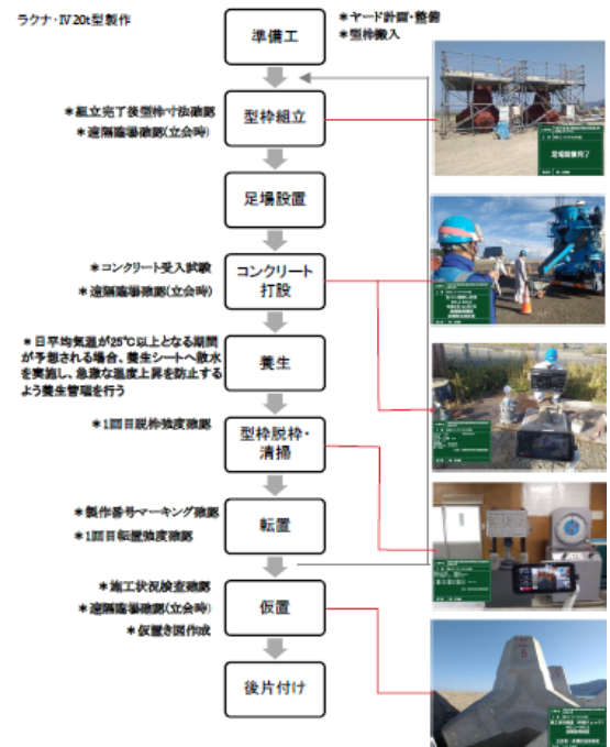
図-4 作業フロー(消波工事, 夏期)
