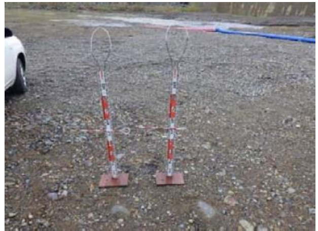
図-15 出来形検測のための定規
