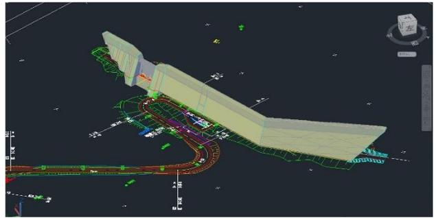
図-7 砂防堰堤・道路のCIMモデル
