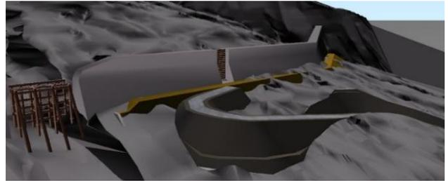
図-8 砂防堰堤・道路のCIMモデル（RGB）
