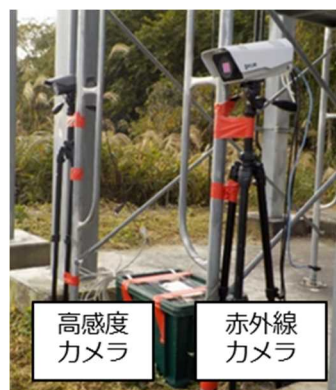
図-12 赤外線カメラの設置状況
