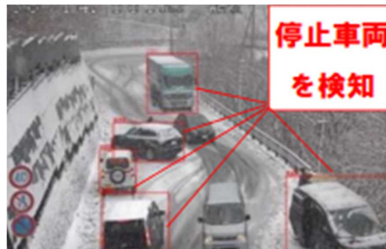
図-3 道路事象検知システム
