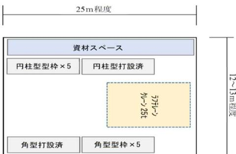
図-7 施工ヤード状況
