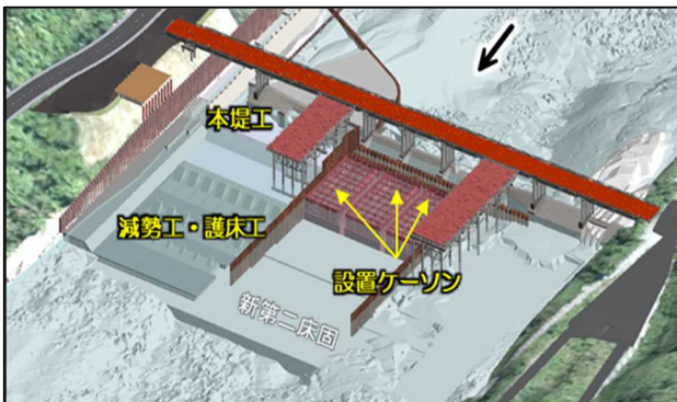
図-2 新第二床固改築工事概要図
