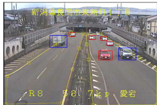
図-1 AIトラカン車両感知イメージ図 (青：大型車，赤：小型車)
