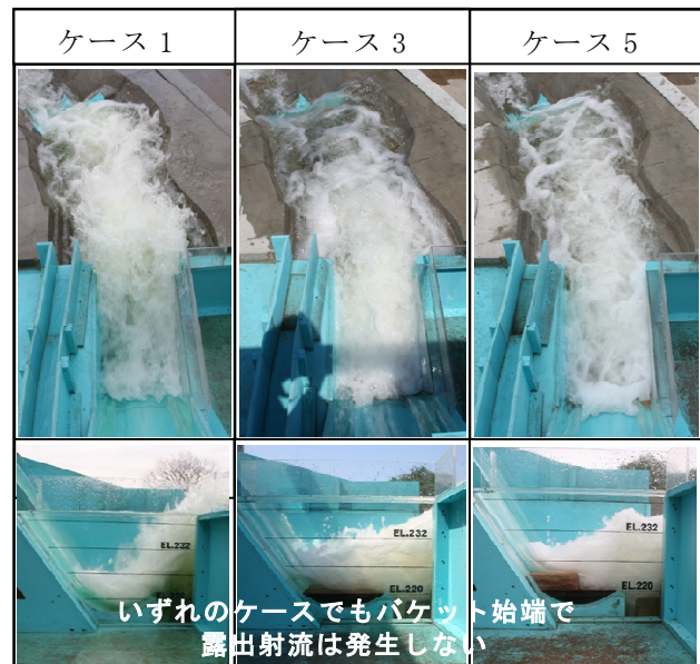
写真-4 既設減勢工改良案の流況
