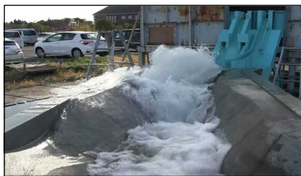
写真-2 改造原案 1,900m 3 /s 流況
