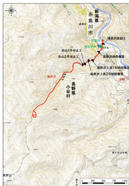
図-6 蒲原沢の土石流の災害状況図
