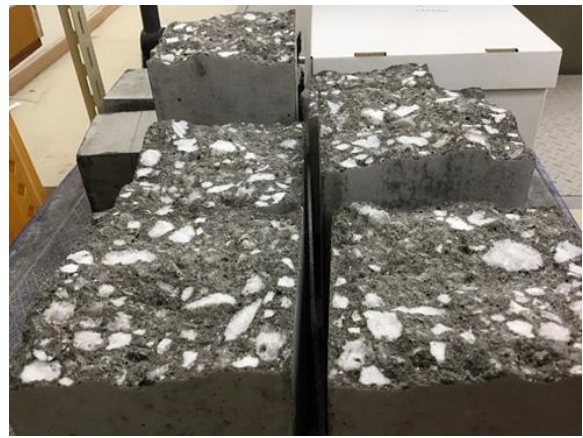
写真-4 No2: アルミナ粗骨材が、一つ一つ割れている。
