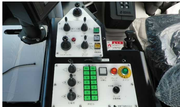
写真-2 除雪トラック作業装置操作レバー
