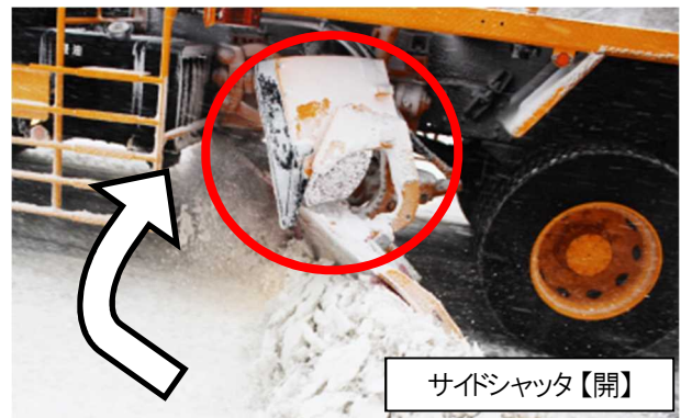
写真-3 サイドシャッタ動作状況
