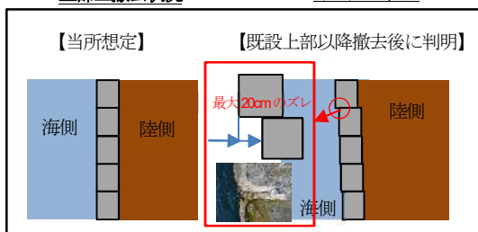
図-7 既設防波堤の設置状況①
