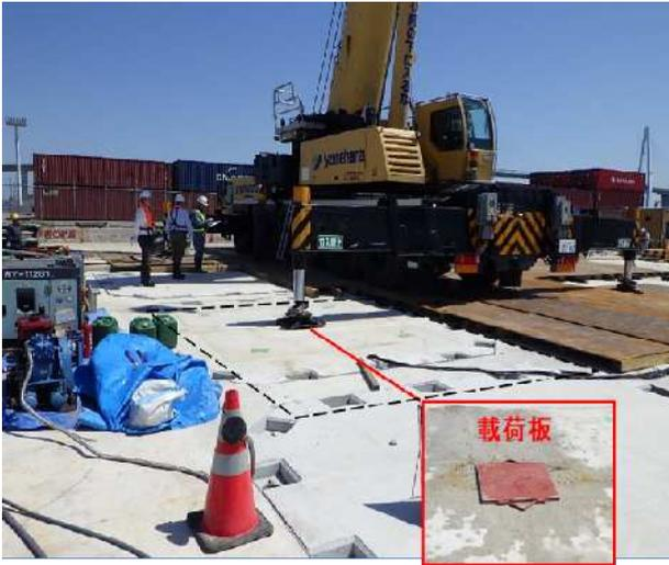
写真-1 静的載荷試験実施状況
