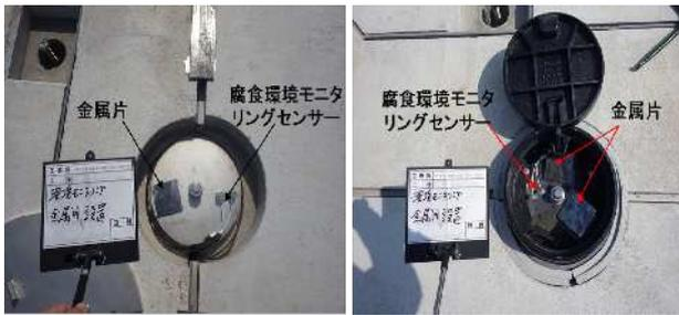
写真-4 座金内計測機器設置状況
