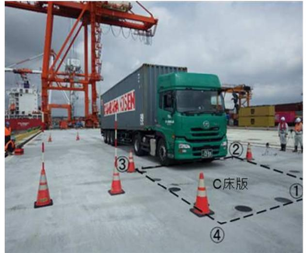
写真-3 動的載荷試験実施状況
