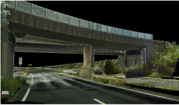
図6 事前測量による3次元点群データ
