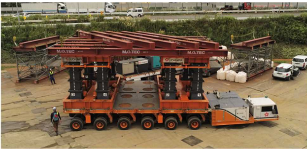
写真5 多軸式特殊台車 (油圧昇降ジャッキ設置状態)
