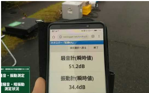
写真-3. 携帯による騒音・振動値の確認
