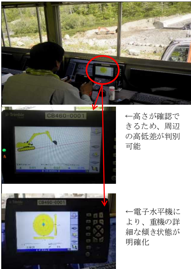
図-5 MGモニターによる高さ・水平確認
