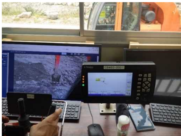
写真-3 MGバックホウのICTモニター (遠隔操作室)
