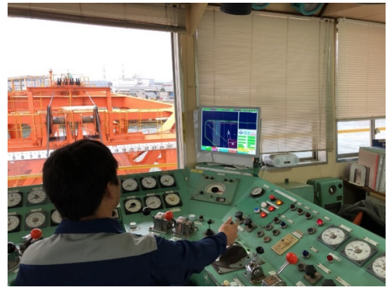
図6 操舵室での施工管理システムによる作業状況
