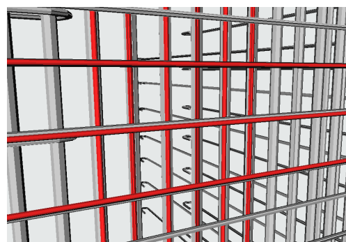
図2 計測結果と CIM モデル比較 (赤: CIM モデル)
