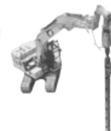
既設杭撤去と撤去跡の締固めを
