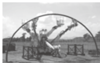
鋼製支保工建込みロボット全景 ▶P.7
