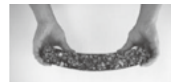
弾性モルタル型凍結抑制舗装 「アイス・インパクト」 ▶ P.25
