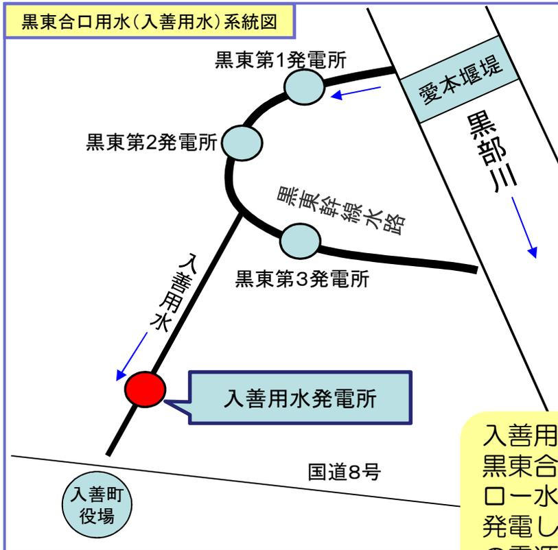
入善用水発電所は黒東合口用水の入善用水に従属する発電所です。黒東合口用水の入善用水に水車発電機（上掛水車及びクロスフロー水車）を設置し、実証試験を実施。発電した電力は、近くの入善高校農場溶液栽培ハウスヒーター等の電源として利用する。
