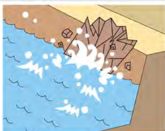
けっそん 欠損 流水や波浪により堤防が削り取られた状態
