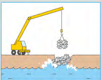
ブロック投入工 大型のブロックをクレーンで吊り、欠損箇所に設置し、堤防を補強する工法
