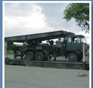
自走架柱橋架設
