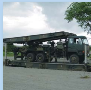
自走架柱橋架設
