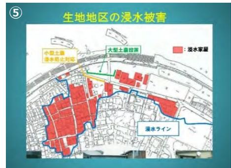
午前 8 時 10 分に現地対策本部にて、どのように応急対応を行うのか関係各所と協議をした結果、海水が町内に入り込まないように、海岸線沿いの道路の路肩に小型土嚢を並べての浸水防止対応、同時に民家に流れ込んだ海水をポンプによる排水対応をすることになりました。さらに国土交通省より堤防から 30m 離れた箇所に大型土嚢を設置するよう指示を受け対応することになりました。当社は主に排水作業と大型土嚢設置を担当しました。当社の作業体制として作業がすべて同時進行となるため、召集した人員 25 名を振り分けて担当作業を決めました。指揮系統としては土木部長を筆頭とし、その指揮のもと各作業班へ指示を出す形態をとりました。
