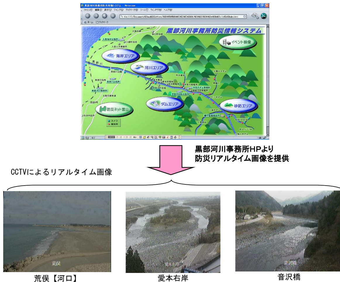
図 3-48 CCTV カメラによる遠隔監視
